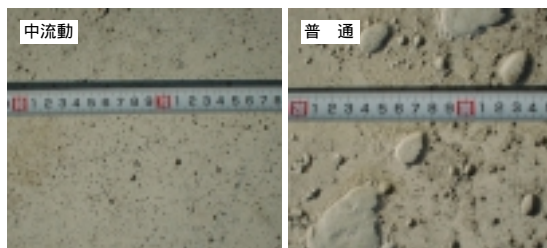
写真-1 下フランジ下面の残留気泡の状況
