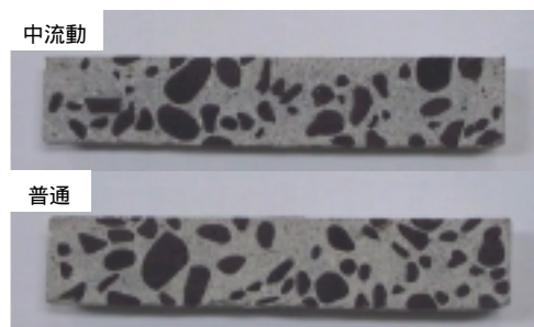
写真-3 コア断面の粗骨材分布状況
