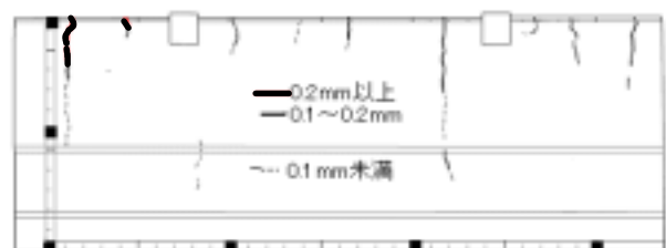
図-2 ひび割れトレース図
