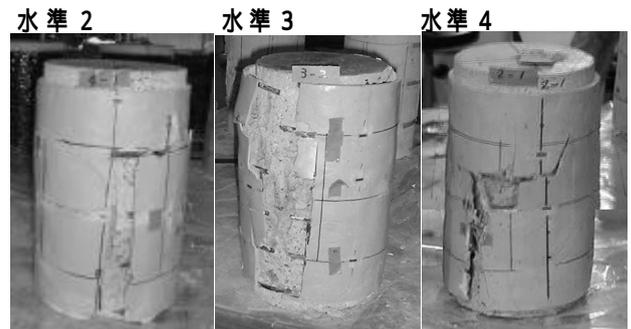
写真 1 供試体破壊状況
