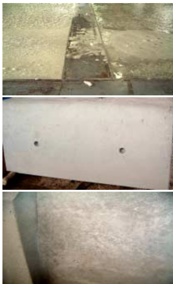
写真-6 実打設(フライアッシュ使用)コンクリート (上: 打設中 左部 PB-1 使用, 右部 PC 使用, 中: PB-1 使用, 下: PC 使用)
