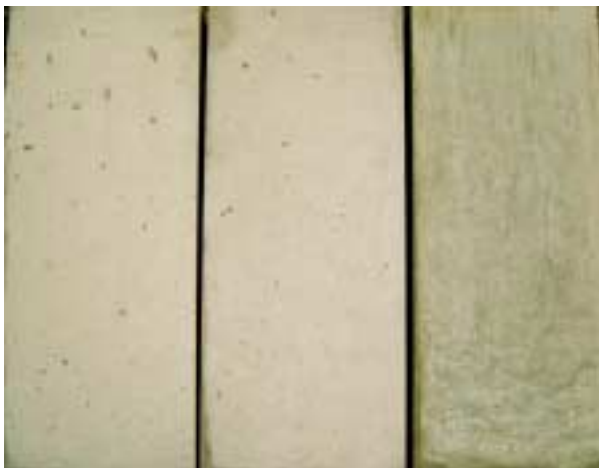
写真-3 フライアッシュ使用コンクリート肌面の違い (左 PB-2, 中央 PB-1, 右 PC)
