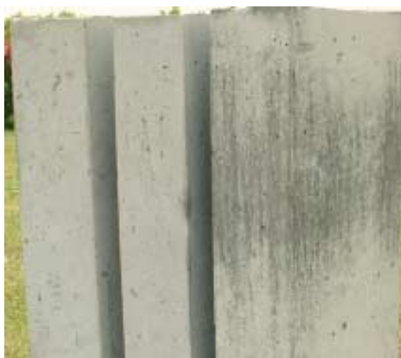
写真-4 頁岩砕砂使用コンクリート肌面の違い (左 PB-2, 中央 PB-1, 右 PC)
