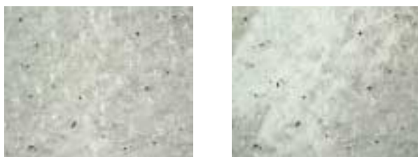
写真-1 左：黒ずみ写真 右：左の写真の製品を手で擦った後の写真
