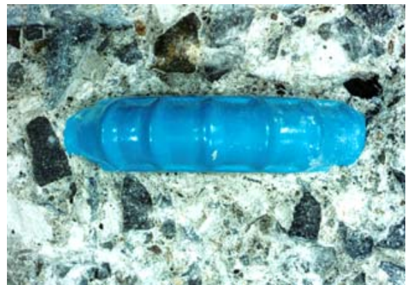
写真-7 曲げ加工した鉄筋の外観 (海洋暴露5年)
