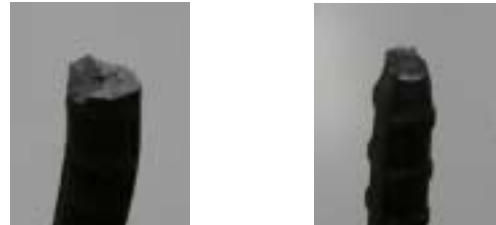
写真 - 1 脆性破断面 写真 - 2 延性破断面
