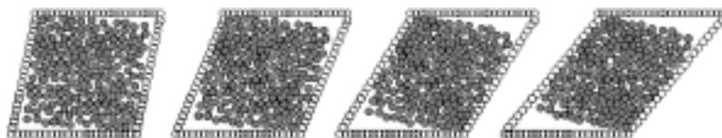
図-6 せん断ボックス試験の解析結果
