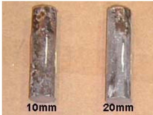
写真-1 セメントコンクリート中の鉄筋
