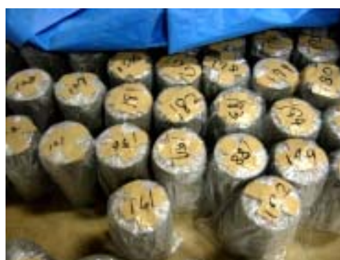
写真-4 封緘養生状況
