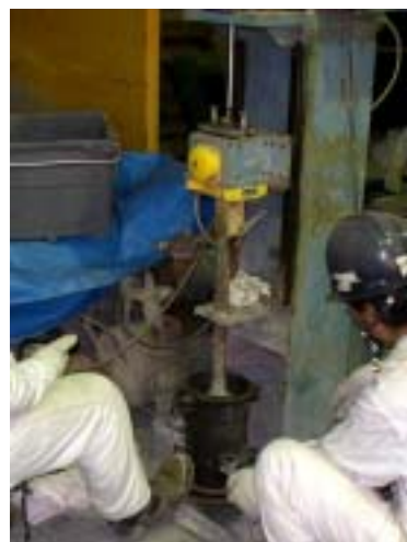
写真-3 供試体作製状況
