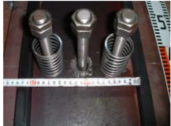
写真 - 1 スパイラル筋の配置 (9巻)
