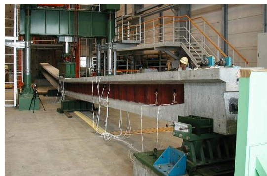
写真 - 2 破壊状況（全景）
