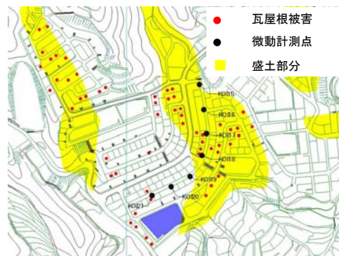
図 2.2 屋根被害・地盤と常時微動計測地点 (西区己斐上5丁目)
