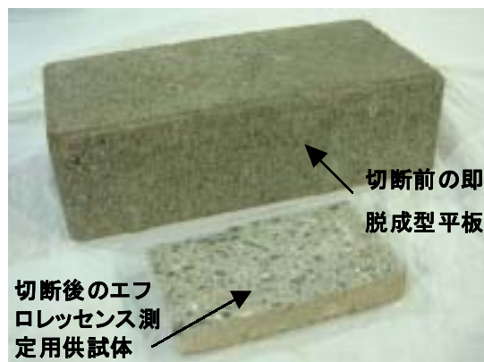
写真-1 即脱成型平板と切断後のエフロレッセンス測定用供試体
