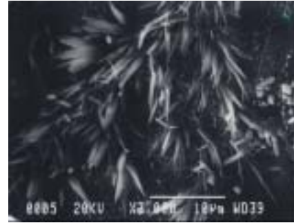
写真-4 セメント供試体表面の不溶性エフロレッセンス
