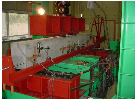
写真-1 実験装置および荷重試験状況
