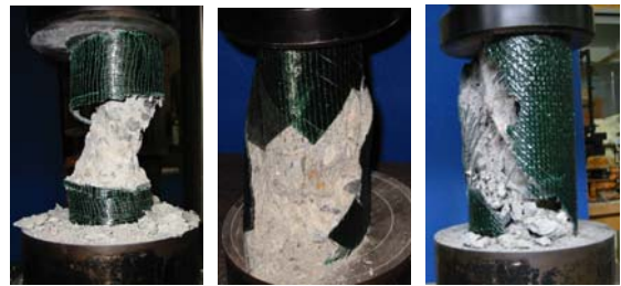
No. 90-1 No. 45/45-1 No. 45/90/45-1 写真-1 圧縮破壊状態
