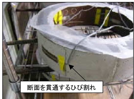
写真-1 拘束大供試体のひび割れ
