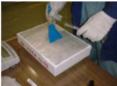
(a) ヘラによる塗布状況
