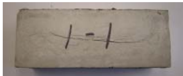
写真-1 CIF 試験における供試体上面のひび割れ (No.1)
