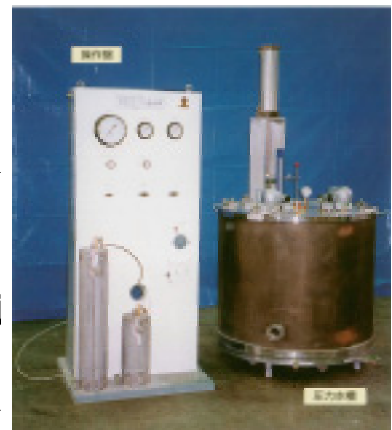
写真-3 高压試験装置写真
