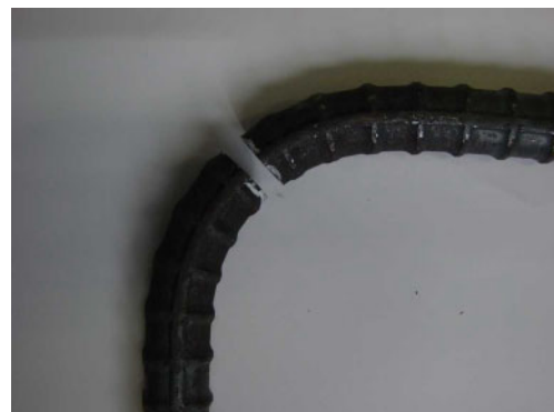
図-4 模擬試験体の切断鉄筋
