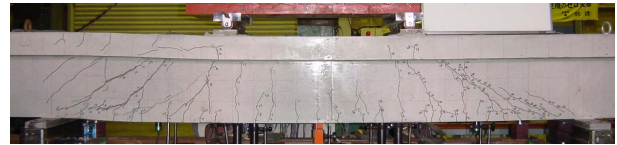
図-3 最終ひび割れ状況 (T1H)
