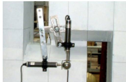
図-3 変位計取付状況
