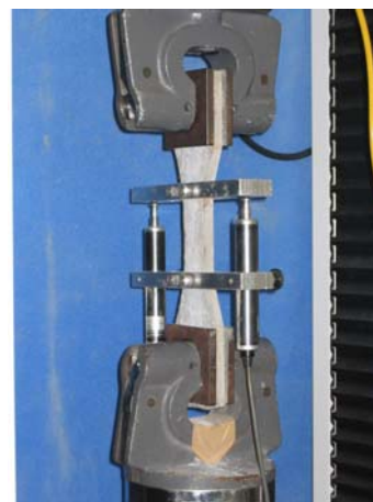
写真-1 引張試験の実施状況
