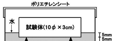
図-1 下面吸水試験
