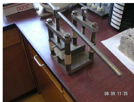
写真-1 ひび割れ導入方法
