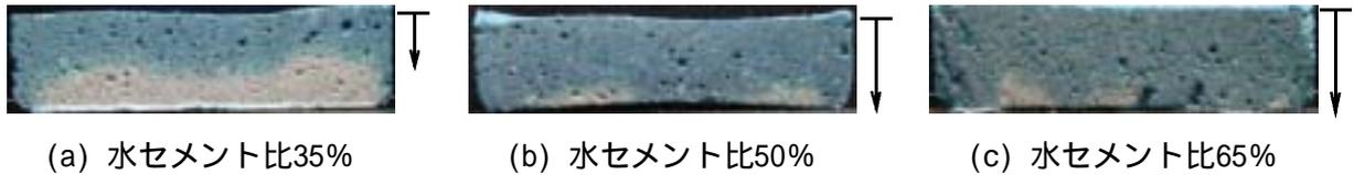
写真 - 2 硬化後の試料切断面(実験2)
