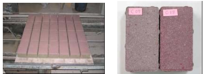
写真-1 製作した IL ブロックの外観
