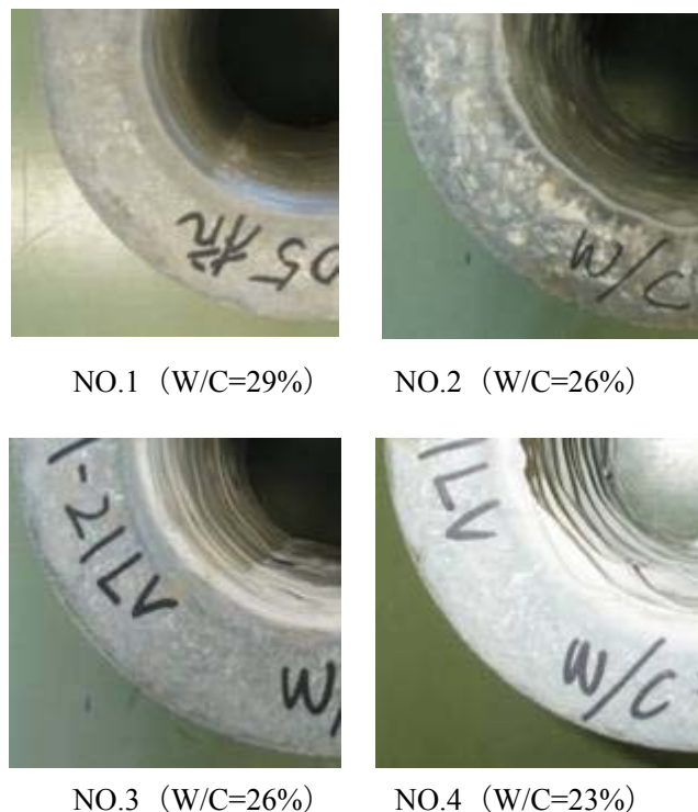
写真-1 遠心成形後の供試体状況 (実験 1)
