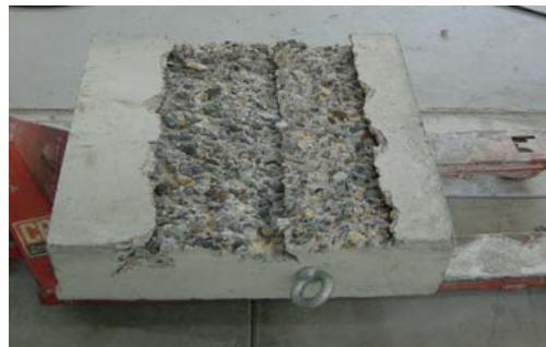
写真-4 WJ 工法による切削後の試験体
