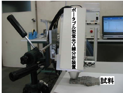
写真-2 ポータブル型蛍光 X 線分析による測定
