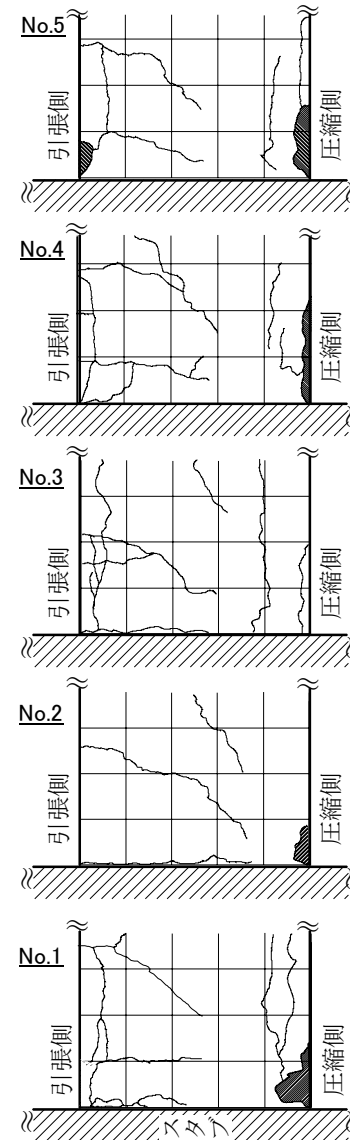
図-5 ひび割れ図 (R=1/50時)
