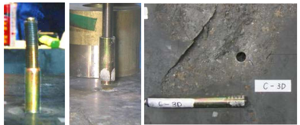
図-3 金属系アンカー施工・破壊状況
