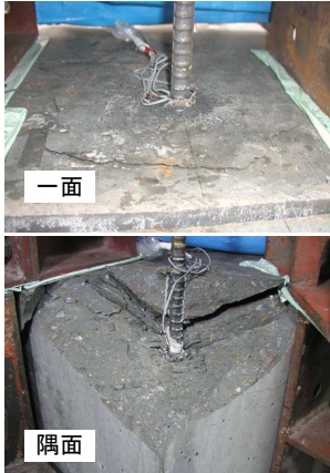
図-9 母材破壊状況
