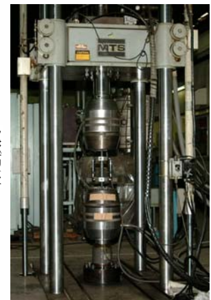
写真-1 1000kN 油圧サーボ型疲労実験機
