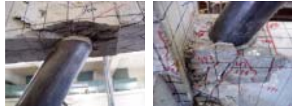
(a)右側上梁底面 (b)左側基礎梁表面 写真 - 2 接合部の最終破壊状況
