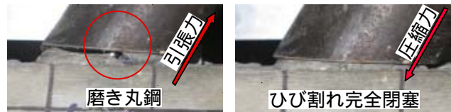
(a)引張状態 (b)圧縮状態 写真 - 1 基礎梁側のひび割れ開閉状況
