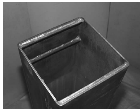
写真 - 1 リブプレート取付け状況 (2 段取付けた場合)
