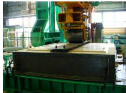
写真-1 輪荷重走行試験実施状況
