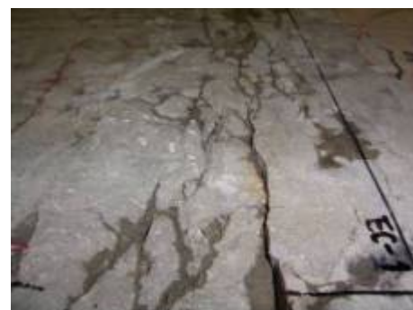
写真-3 載荷版直下の最終状況
