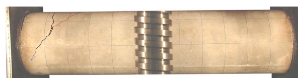
No.3 最終破壊状況
