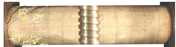
No.2 最終破壊状況
