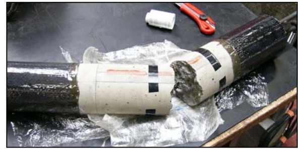
写真-3 供試体の破断状況
