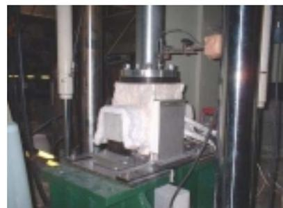
写真-1 環状電気炉(上)と加熱載荷装置(下)
