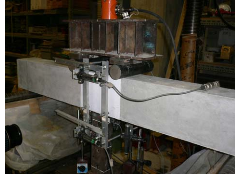
写真-1 静曲げ試験
