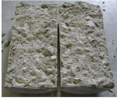
写真—2 割裂引張試験後の破壊断面例
