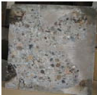
写真-2 加熱面の剥離状況 (湿潤供試体)
