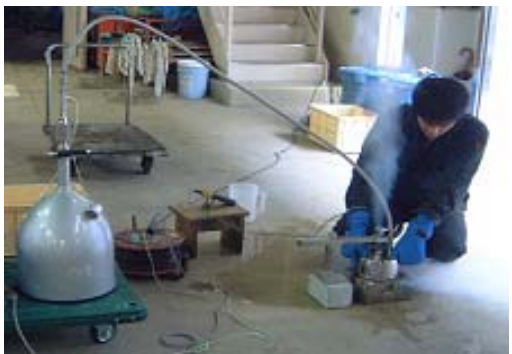
写真 - 2 平板供試体を用いた簡易凍結融解試験の実施状況
