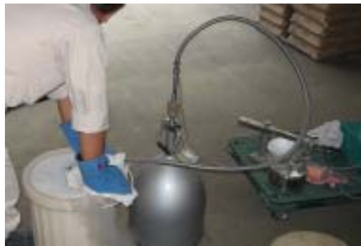
写真 - 1 円柱供試体を用いた簡易凍結融解試験の実施状況
