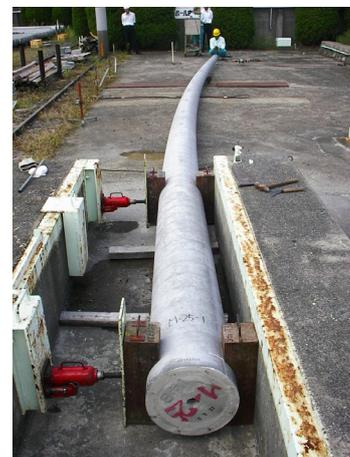
写真-2 ポール曲げ試験状況
