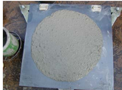
写真-2 試験時のコンクリートの状態
