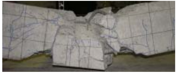
写真-2 衝突速度漸増繰返し試験での破壊性状
