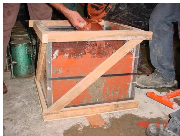
写真-1 透明型枠を用いた室内試験
