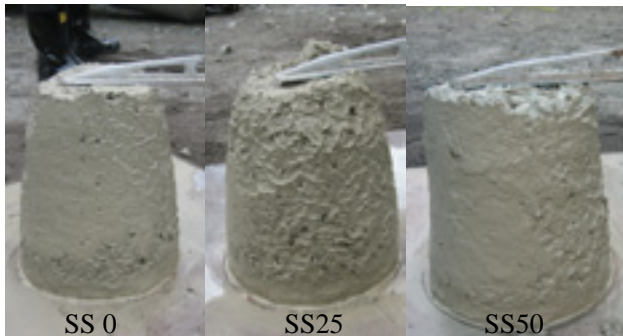
写真 - 1 スランプの試験状況
