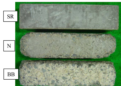
写真-2 52週間浸せき後の供試体の外観 (10%Na 2 SO 4 溶液, W/C=55%)
