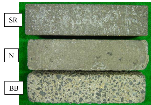
写真-1 52週間浸せき後の供試体の外観 (10%MgSO 4 溶液, W/C=55%)
