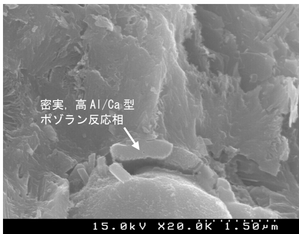
写真-2 初期卓越型に多い反応相 (F, 材齢 378 日)
